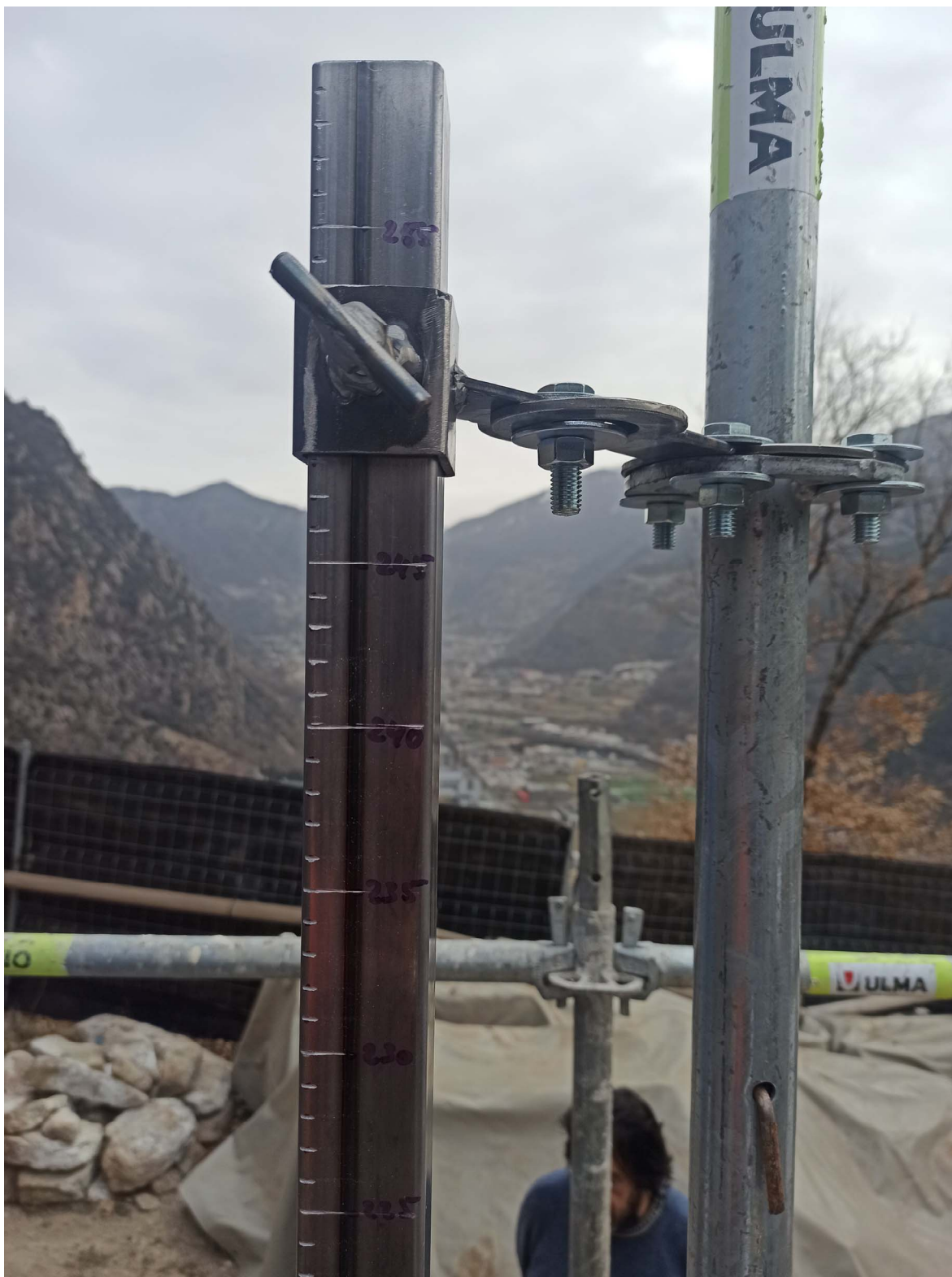
Fotografia 8. Detall d'un dels quatre regles verticals del sistema de referència de coordenades emprat
