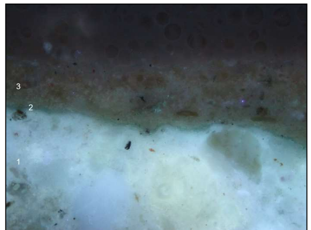
Figura 4a.- Imatge obtinguda al microscopi òptic de la secció transversal de la micromostra LAB-30.7 il·luminada amb llum UV (objectiu MPlan 20X/0,45). El ordre numèric que s'indica es el que apareix a la taula corresponent.
