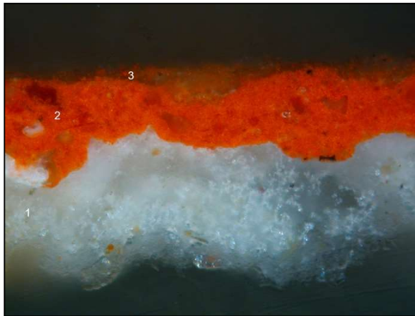
Figura 3.- Imatge obtinguda al microscopi òptic de la secció transversal de la micromostra LAB-30.5 (objectiu MPlan 20X/0,45). L'ordre numèric que s'indica es el que apareix a la taula corresponent.
