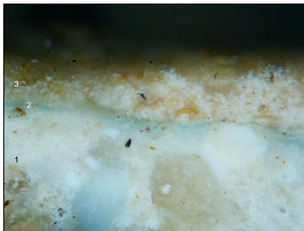
Figura 4.- Imatge obtinguda al microscopi òptic de la secció transversal de la micromostra LAB-30.7 (objectiu MPlan 20X/0,45). L'ordre numèric que s'indica es el que apareix a la taula corresponent.
