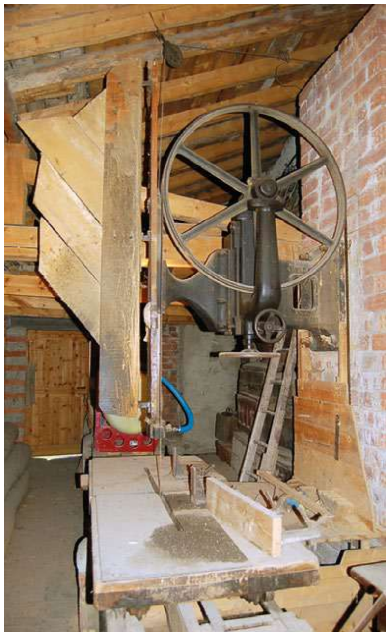
Serra de cinta de la serradora I Nicolau (Fotografia PC)
