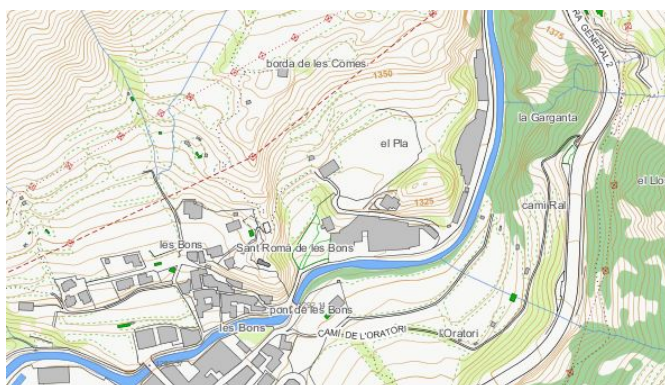
Figura 7. Exemple de base topogràfica 1:5000 (zona Encamp)
