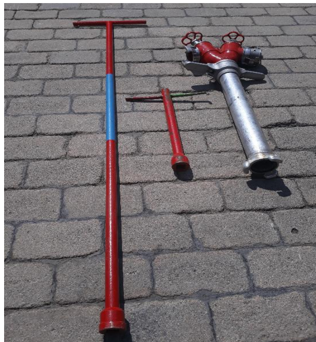
eines d'obertura d'hidrants soterrats
