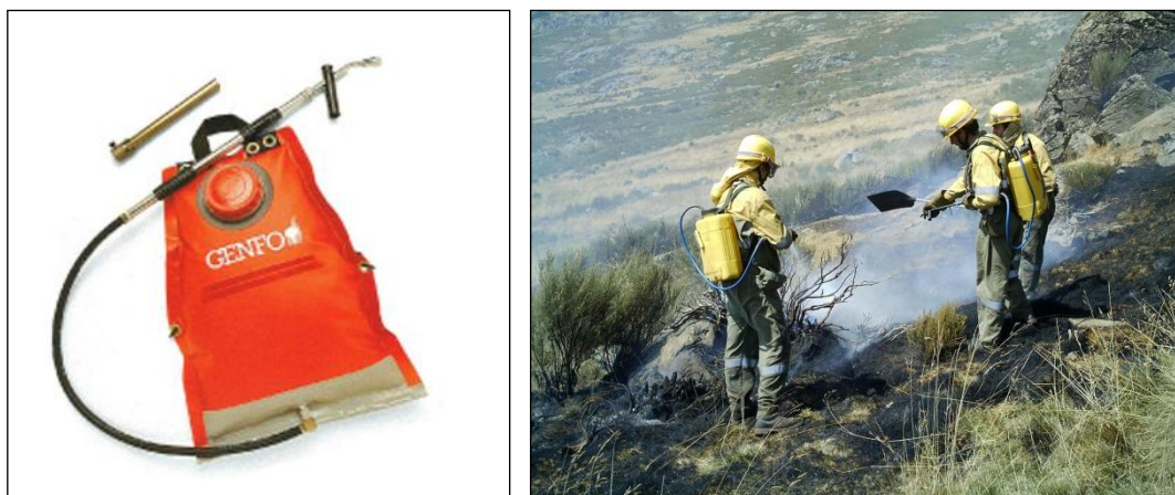
Figura 22.- Motxilla extintora i utilització en tasques d'extinció. Foto: J. Blanco 2005
