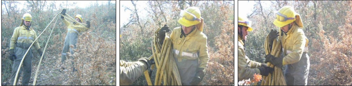
Figura 33.- Sistema de plegat de mànegues en madeixa. Foto: J: Blanco 2005
