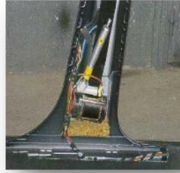
Diferents ubicacions de pretensors pirotècnics acoblats a l'enrotllador
