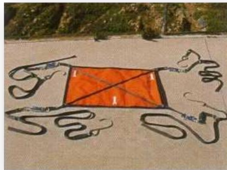
Protector d'airbag d'acompanyant (molt complicat de muntar).
