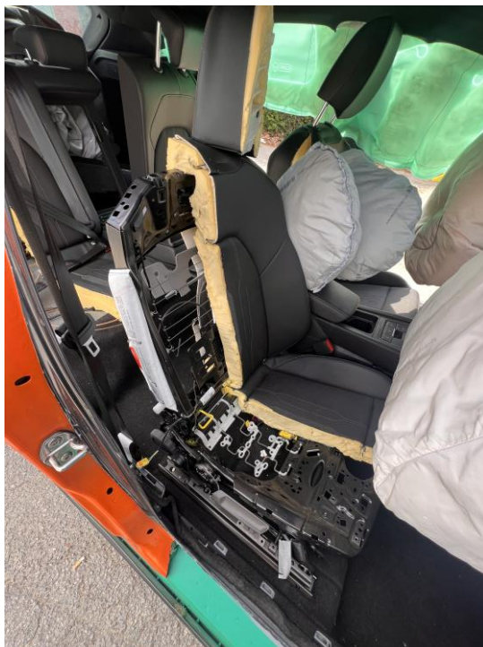
Sistema mecànic del recolzacaps
