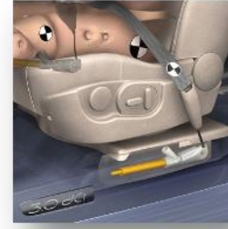
Diferents ubicacions de pretensors pirotècnics acoblats a l'enrotllador
