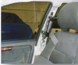
Diferents ubicacions de pretensors pirotècnics acoblats a l'enrotllador
