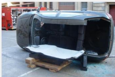
Talls del sostre amb serra de sable
