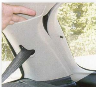
Es molt important treure plàstics a l'hora de fer un tall.
