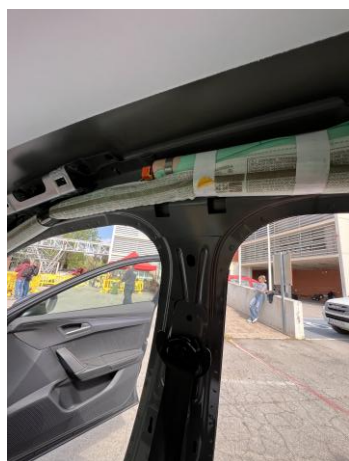
Es molt important treure plàstics a l'hora de fer un tall.
