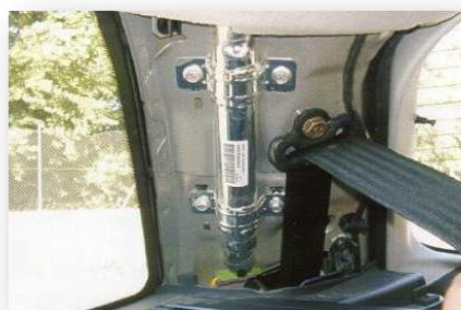
Es molt important treure plàstics a l'hora de fer un tall.
