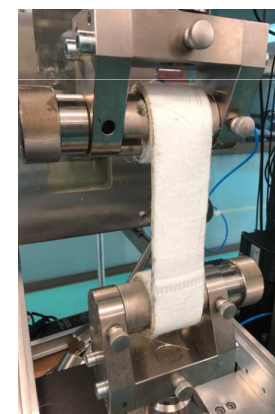
Assaig de tracció (tèxtil)
