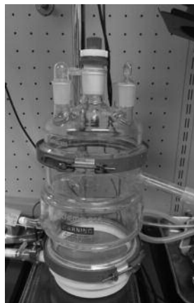
Figura 4. Digestor que imita el comportament del rumen
